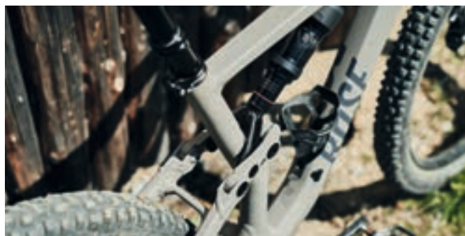
Volle Kontrolle, tolle Ästhetik: neues Suspension Design am Hinterbau mit horizontalem Dämpfer – inline mit Oberrohr und Sitzstreben
