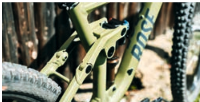
Stehender Dämpfer und Trunion Mount: Das neue Hinterbau-Design garantiert ein besonders sensibles Ansprechverhalten
