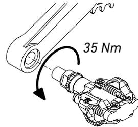
3. Tournez la pédale droite dans le filetage de la manivelle droite dans le sens des aiguilles d'une montre et serrez-la avec une clé dynamométrique au couple de 35 Nm.
