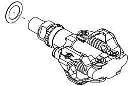
2. Drehe das linke Pedal gegen den Uhrzeigersinn in das Gewinde im linken Kurbelarm und ziehe das Pedal mit einem Anzugsdrehmoment von 35 Nm fest.
