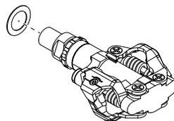
2. Avvita il pedale sinistro in senso antiorario nella filettatura del braccio della pedivella di sinistra e stringi il pedale con una coppia di serraggio di 35 Nm.
