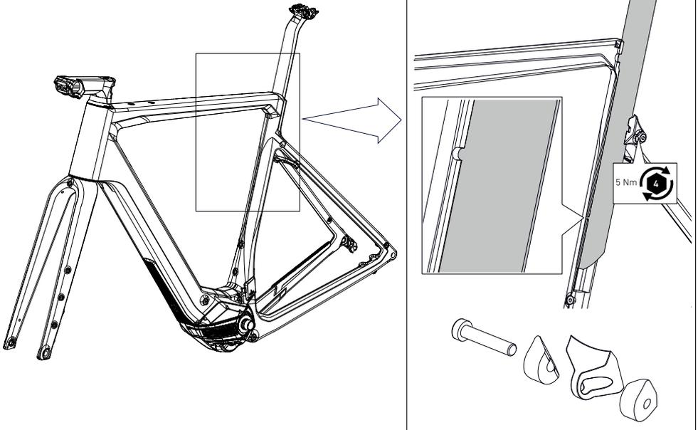
1. Open de klamschroef. LET OP: Draai de klamschroef niet helemaal los!
