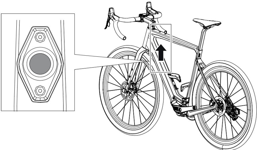
1. Appuyez sur la touche On/Off (Marche/Arrêt) située sous le tube horizontal et maintenez-la enfoncée brièvement.
