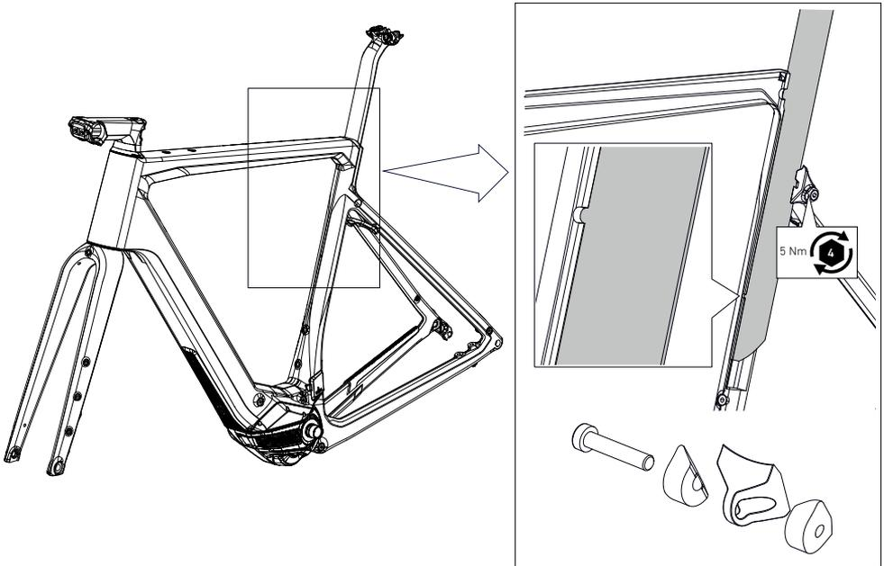
1. Svita la vite di serraggio. **ATTENZIONE:** Non svitare completamente la vite di serraggio!
