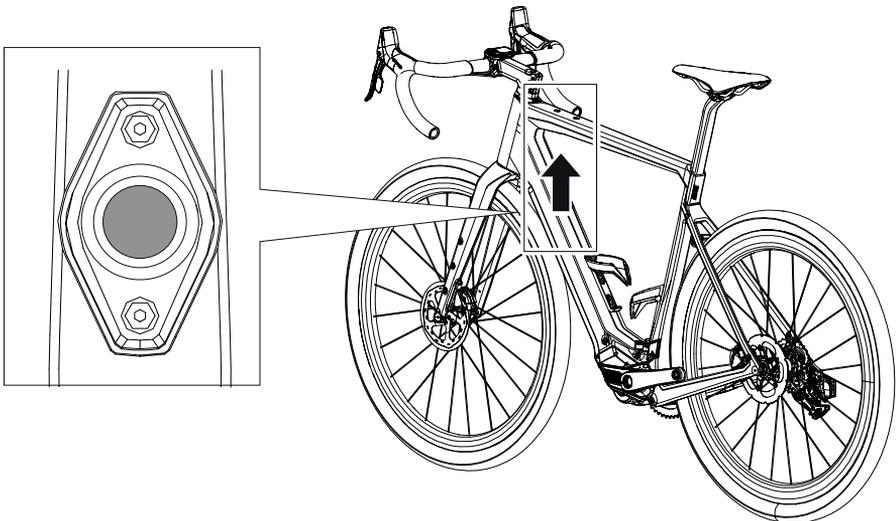
1. Drücke die On/Off Taste auf der Unterseite des Oberrohrs und halte die Taste kurz gedrückt.
