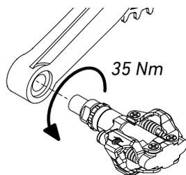
3. Avvita il pedale destro in senso orario nella filettatura del braccio della pedivella di destra e stringi il pedale con 35 Nm.
