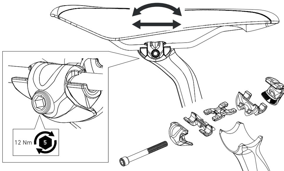
1. Desserrez la vis de serrage de 2 tours environ. ATTENTION: Ne dévissez pas complètement la vis de serrage!
