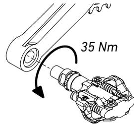
3. Drehe das rechte Pedal im Uhrzeigersinn in das Gewinde im rechten Kurbelarm und ziehe das Pedal mit 35 Nm an.
