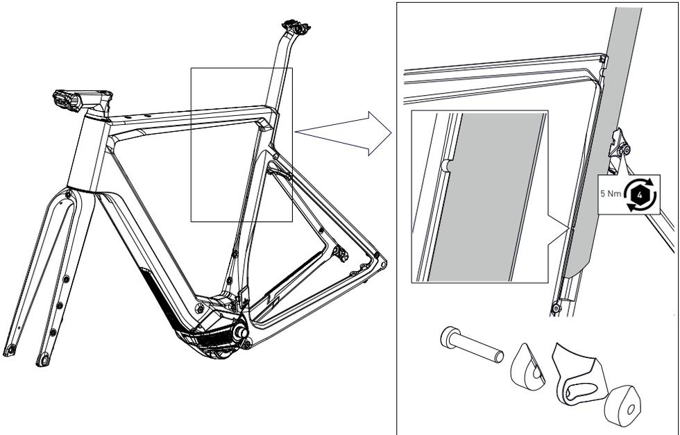
1. Öffne die Klemmschraube. ACHTUNG: Klemmschraube nicht vollständig herausdrehen!
