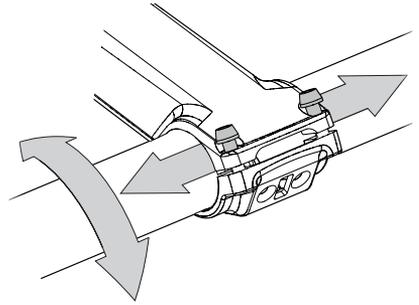
3. D'abord, serrez tour à tour les deux vis inférieures jusqu'à atteindre un couple de 8 Nm.
