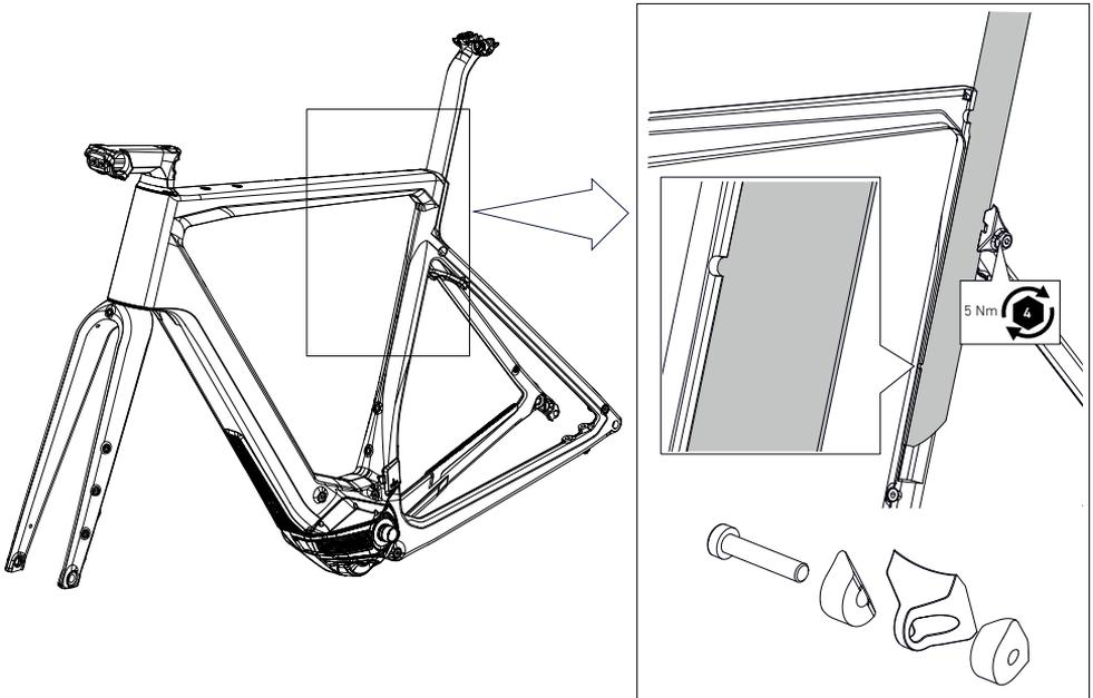
1. Desserrez la vis de serrage. ATTENTION: Ne dévissez pas complètement la vis de serrage!
