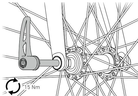
8. Hebel des RWS anheben (A), in die gewünschte Position drehen (B) und loslassen (C).
