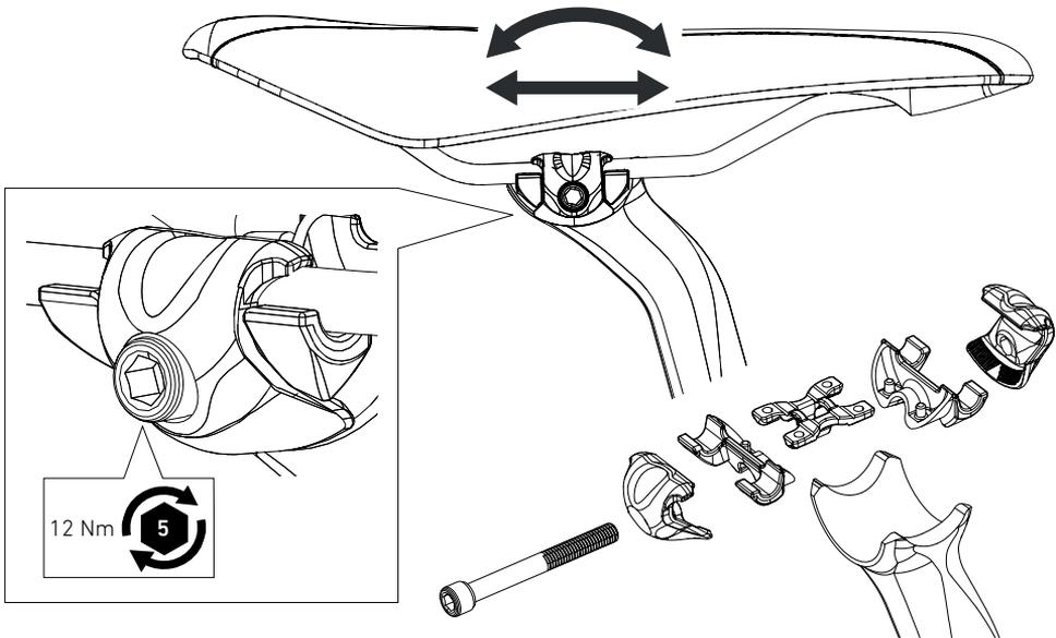
1. Öffne die Klemmschraube etwa 2 Umdrehungen. ACHTUNG: Klemmschraube nicht vollständig herausdrehen!
