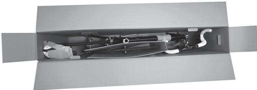
1. Alle losen oder beweglichen Teile fixieren oder ausreichend ummanteln. Scharfe oder spitze Komponenten müssen zusätzlich ummantelt werden, damit sie im Karton keine Schäden verursachen und nicht nach außen durchschlagen können.
