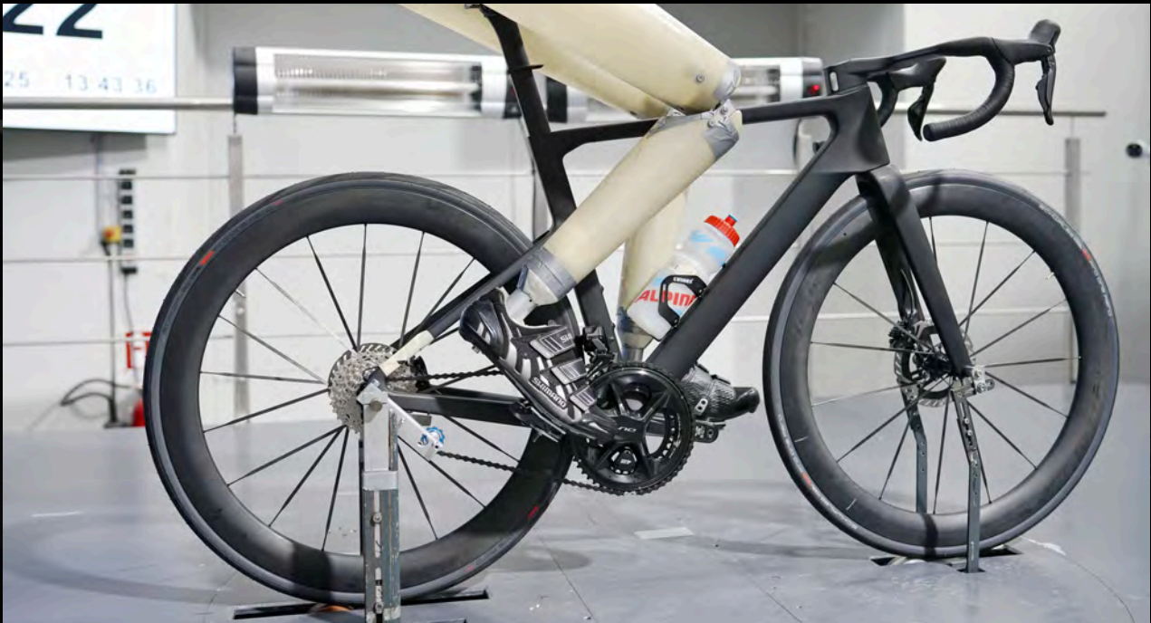
Abbildung 7: Test-Aufbau des Shave-Prototyps im GST-Windkanal © Robert Kühnen
